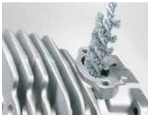
Микроабразивная щетка д/внутр. обработки
